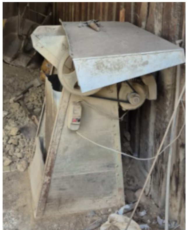
Imagen N° 7: Molinillo. Usado para triturar materia prima extraída y aminorar tiempo y exposición a fuerza excesiva, antes usaba martillo machacador a pulso.
