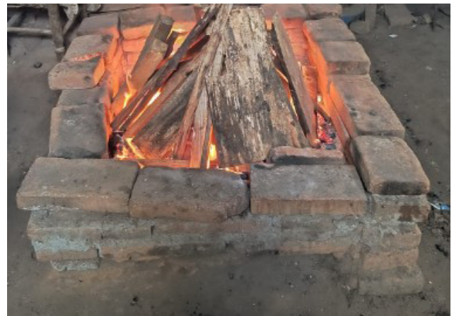
Imágenes N° 10: Carbón y Madera. Material para avivar y mantener temperatura de cocción de piezas de greda.
