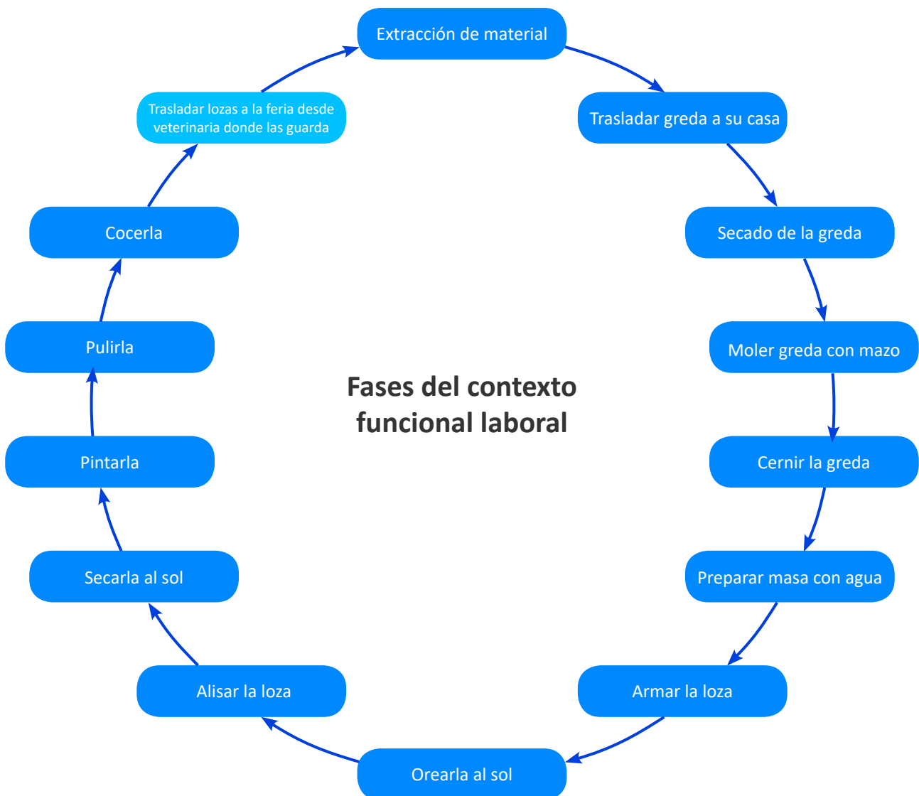
Esquema N°1: Fases elaboración de loza. Se mencionan las fases para la producción del producto “plato de cazuela”. Fuente: Elaboración propia.
