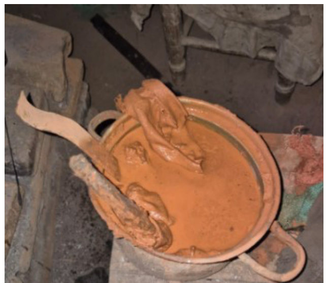
Imagen N°11: "Colo". Mezcla de greda molida con agua para pintar losa.
